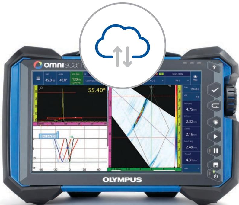
可以将数据连接到奥林巴斯科学云系统的无线连通性能, 可使用户更有效地进行协同合作, 并对相控阵数据进行无缝管理工作。
